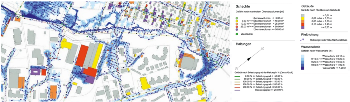
Beispiel einer Überflutungsberechnung
